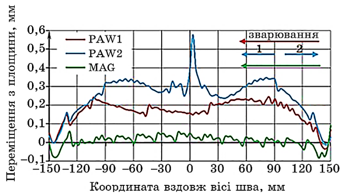
Рис. 11. Розподіл залишкових переміщень з площини вздовж осі зварного шва стикового з'єднання для різних технологічних схем зварювання.
